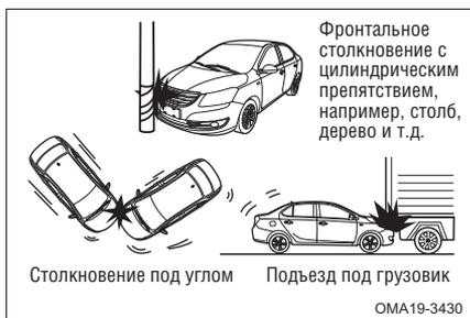
Подушка безопасности может не сработать, если автомобиль столкнулся со столбом, который не может быть сломан, при подъезде под грузовой автомобиль или другое препятствие, либо автомобиль попал в столкновение под углом, как показано на рисунке.
