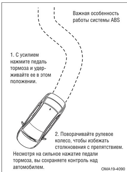
Антиблокировочная система (ABS) срабатывает немедленно при резком торможении, что сохраняет тормозные качества и управляемость автомобиля. При достаточном расстоянии до препятствий вы даже сможете объезжать их.
