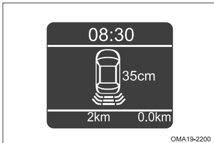
Если замок зажигания находится в положении ON, а рычаг переключения переведен в положение R (Задний ход), то при обнаружении препятствия на многофункциональном дисплее будет отображена информация системы помощи при движении задним ходом.
