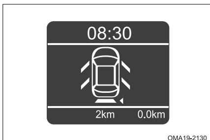
Если открыта любая дверь или крышка багажника, то на многофункциональном дисплее будет показано состояние четырех дверей и крышки багажника.
