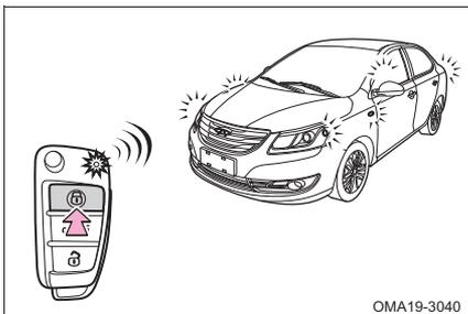
Нажмите кнопку запирания на ключе с пультом дистанционного управления для запирания замков всех дверей, при этом все указатели поворота мигнут один раз и один раз прозвучит противоугонная сигнализация. Индикатор противоугонной системы мигает постоянно для подтверждения ее включения. Противоугонная система включена.
